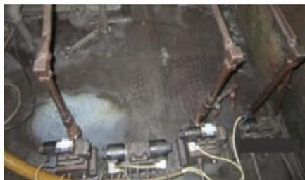
图11 改造前用液压阀组控制切削液
