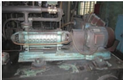
图10 改造后用高压离心泵供切削液
