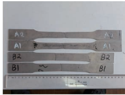
图8 冲裁样品与机加工样品的拉伸性能结果
