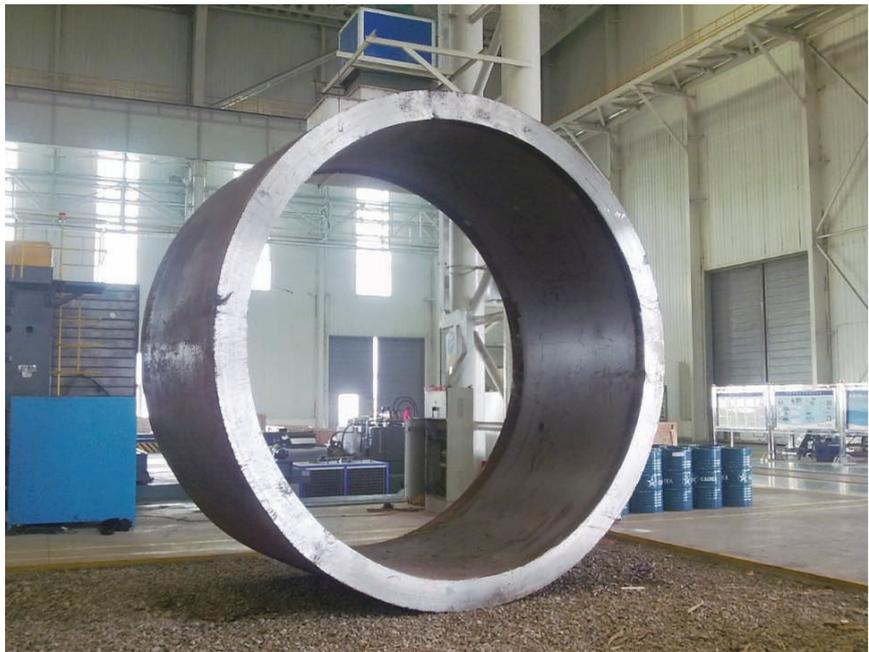
196mm, 材质SA387Gr22CL2, 内径为3700mm, 将其中一节筒节的板厚增至240mm, 以验证兰石卷板成型工艺及设备能力。本项目的开发需要解决以下难点:
