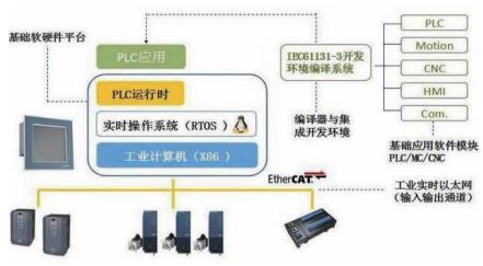
图2 整体控制网络架构设计
