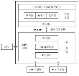
图5 符合IEC61131-3标准的软PLC体系结构
