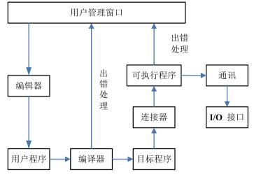
图6 软PLC集成系统开发设计
