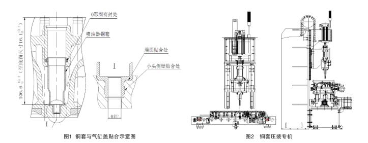
铜套装配压装过程为: 先人工清理气缸盖油嘴孔小头平面及油嘴孔大头槽,放入O形密封圈、铜套大头处涂凡士林、人工放入喷油器铜套,并用辅助工具预压铜套至孔内,同时放入胀杆至油嘴孔小头孔内、工件通过滚道输送到压装位置,定位、夹紧,第一缸活塞杆先动作将铜套端面与喷油器孔端面压贴,并保证铜套下端内表面至顶面尺寸,通过液压系统进行保压;第二缸活塞杆再动作,推动胀压工具通过油嘴孔小头,从而使铜套小头外壁与气缸盖喷油器小头孔壁紧密贴合,依次完成1至6缸压装,完成铜套装配。
