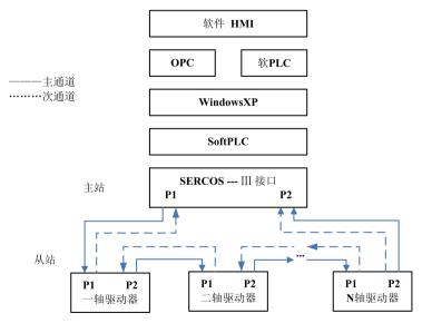
图4 基于软PLC的拧紧机控制驱动方案
