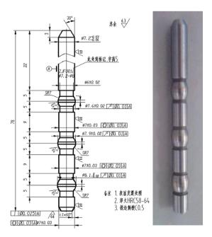
图8 三阶胀杆设计图及实物
