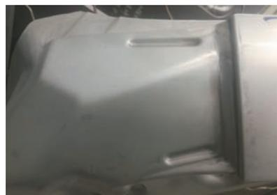
图3-11 A柱增加吸料筋
