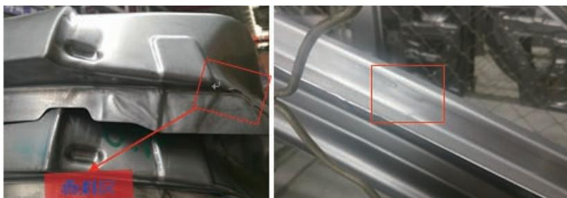
图2-5 B50汽车侧围外板A柱褶皱及风窗处印痕缺陷
