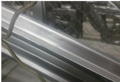
图5-1 B50侧围外板风窗交刀印痕
