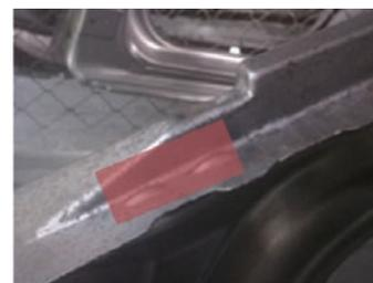
图3-7 B30侧围外板A柱缺陷图
