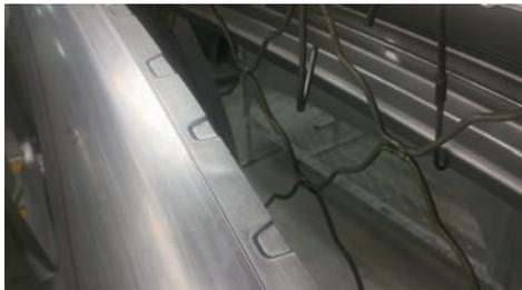
图4-3 侧围外板顶盖法兰面增加工艺包
