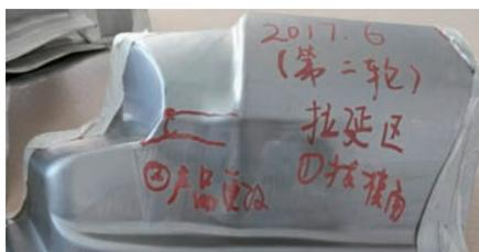
图3-8 拉研凸模拔模角更改
