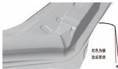
图3-9 A柱拉延拔模角修改
